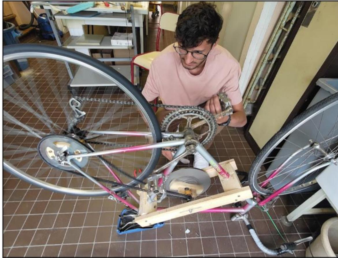
Figure 15: Prise de mesure de la vitesse de rotation de la roue arrière de vélo
