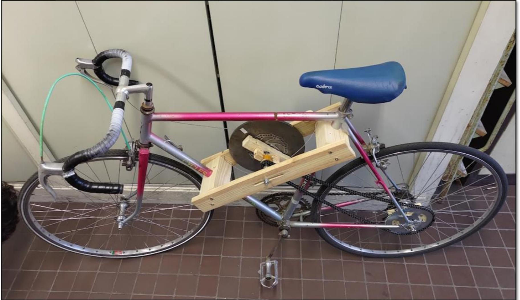
Figure 5: Vélo modifié avec le système de récupération d'énergie
