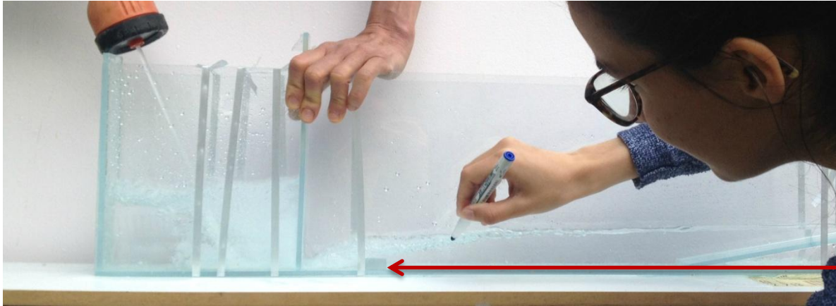
Figure 14 : Troisième dispositif expérimental : simulation d'un cours d'eau et ajout d'un dissipateur d'énergie
