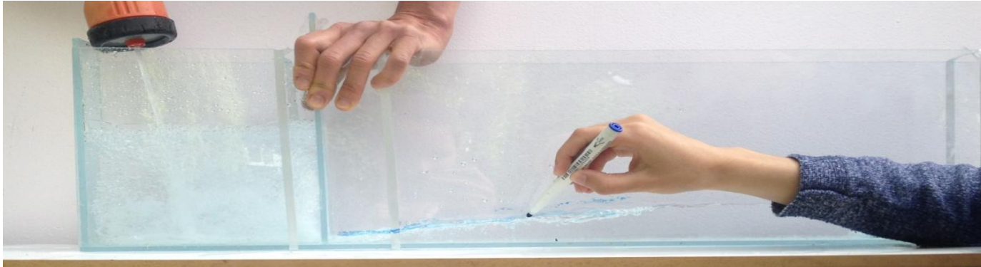
Figure 4 : Premier dispositif expérimental : relevé de la profondeur d'écoulement
