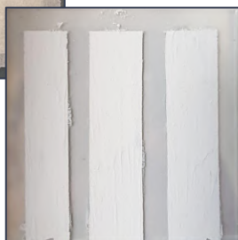
← Figure 5.2 : mise en place de scotch ↗ Figure 5.1 : étalement du semi-conducteur
