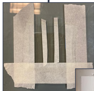
← Figure 5.2 : mise en place de scotch ↗ Figure 5.1 : étalement du semi-conducteur
