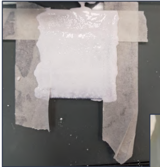
← Figure 1.3 : étallement de la pâte ← Figure 1.2 : pâte du semi-conducteur
