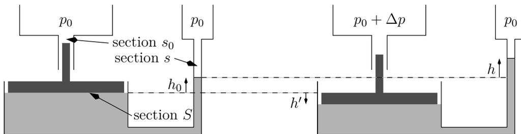
1. Exprimer le déplacement  $h$  du niveau de liquide en fonction de la variation de pression  $\Delta p$ , de la masse volumique de l'eau  $\rho$ , de  $g$  ainsi que des différentes sections.
