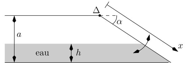
La conduite est occupée par de l'eau de masse volumique  $\rho$  sur une hauteur  $h$ . La surface de l'eau, comme l'extérieur du clapet, est à la pression  $P_0$ .
